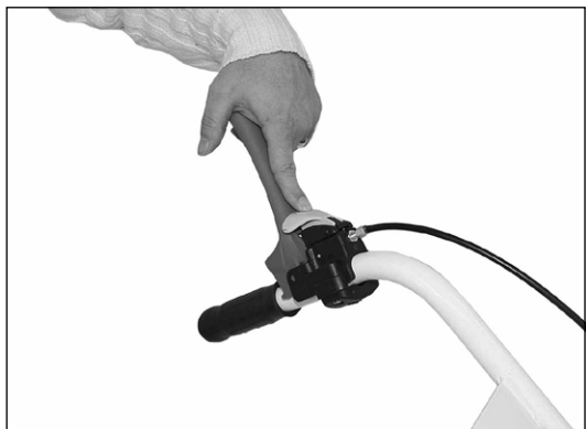
1) En appuyant sur le levier latéral, le dispositif d'arrêt du levier d'embrayage est libéré.
