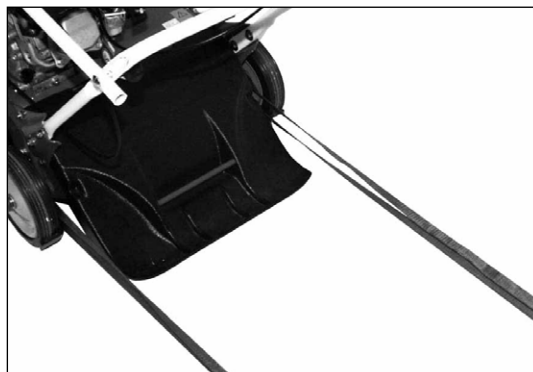
2) Transport avec un véhicule : fixez l'appareil avec des sangles. Les essieux avant et arrière servent de points de fixation.
