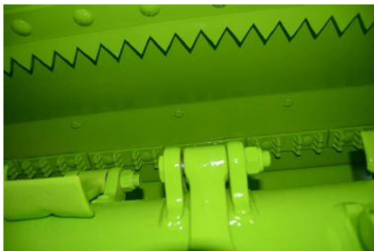
Rotor hélicôïdale avec contre-marteaux très agressifs
