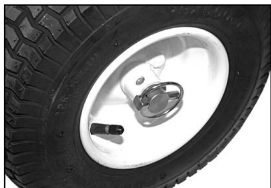
1) Passer en configuration roue libre : ne faire passer la goupille de sécurité qu'à travers l'axe.
