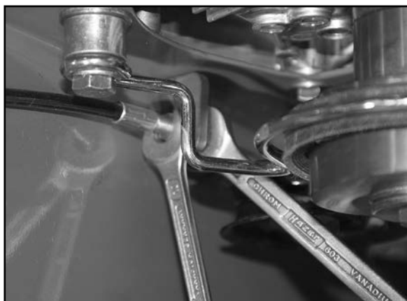
2) Desserrer les écrous. Réajuster le câble.
