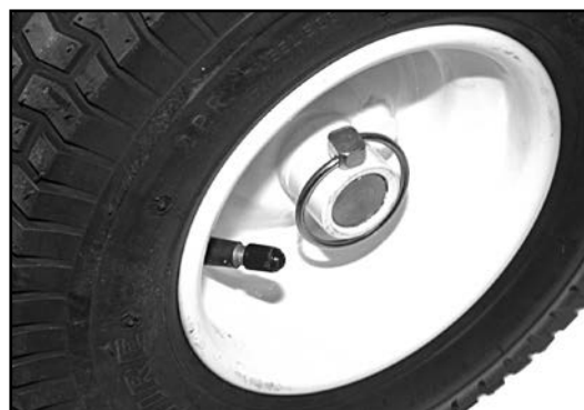
2) Enlever la configuration la roue libre : faire passer la goupille de sécurité à travers l'axe et le moyeu (p. ex. en cas de balayage sur une surface en pente)
