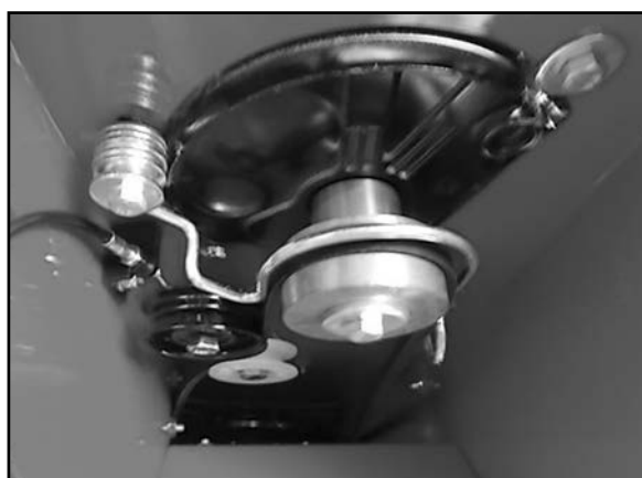
4) Vérifiez la position du tendeur de la courroie trapézoïdale.
