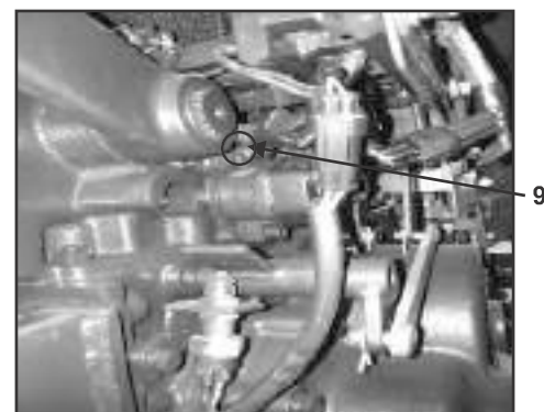
9. Secteur PC sur le carter hydraulique
