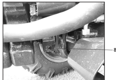
8. Point de graissage (essieu avant 4WD)
