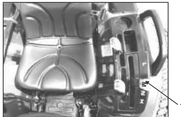
(1) Levier de changement de gamme de vitesse (L-M-N-H)
