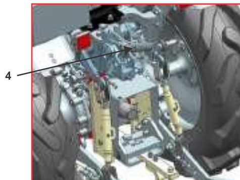
4. Point de graissage (bras supérieur)
