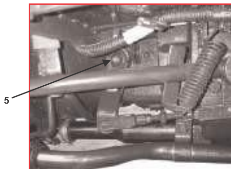
5. Point de graissage (Fuite d'embrayage)
